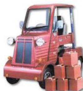
図.1.12 コンボイ 88 鉛バッテリー (鉛バッテリー、重量 21.4kgx6 個 =128.4kg)
