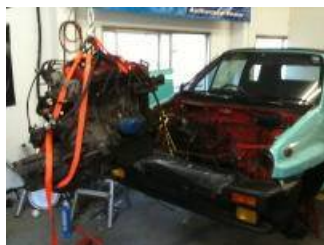
図.1.23 エンジンを下してモーターに 乗せ換える作業
