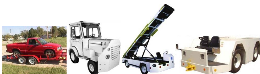
図 2.5 Electric Blue による EV 等の改造例 ポレーS10 の改造 EV（最左）、と空港内における荷役機器類 (出典：Electric Blue HP)
