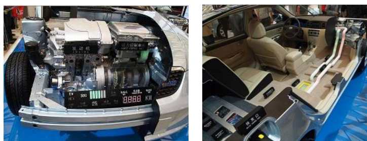
図 2.6 BYD の PHEV 「F3DM」 ガソリンエンジンと電力制御ユニット (左)、ガソリンと電流経路および床下の Li イオン電池 (右) (出典：クリーンテック世界動向 2011/7/20)
