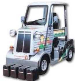
図.1.11 コンボイ 88-Li (リチウムイオンバッテリー、重量 13.8kgx4 個=55.2kg)
