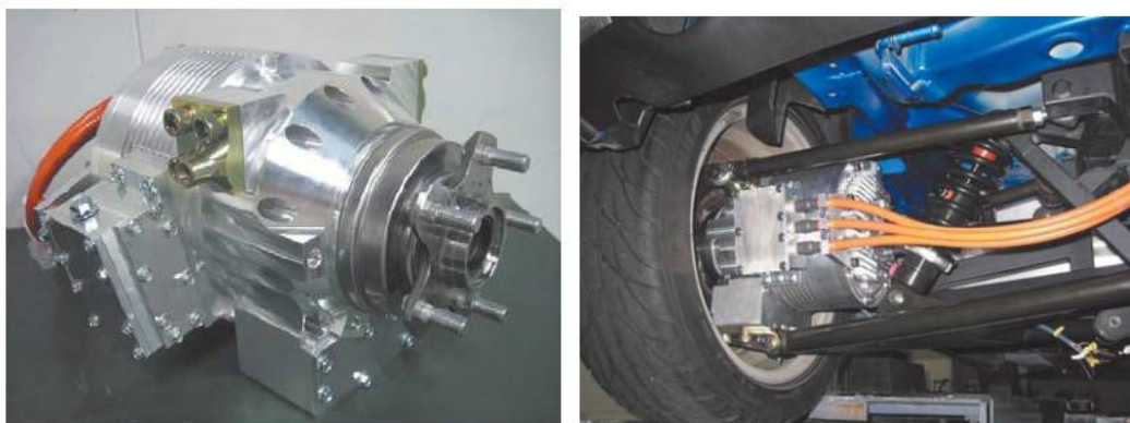
図表 2-16 インホイールモーター本体及び取り付け時の外観とシステム図
