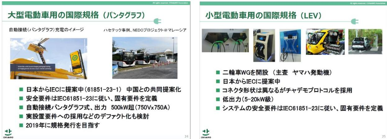
図 5 - 2 1 大型電動車用（左），小型電動車用（右）の国際規格の開発
