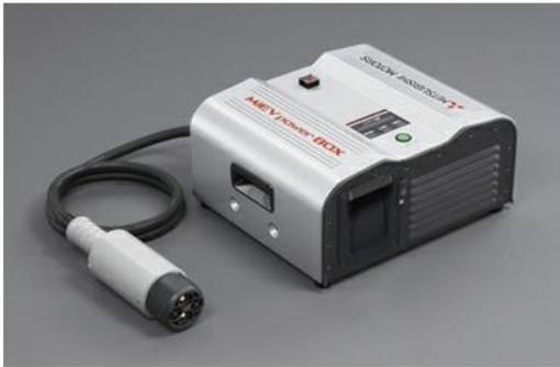
『MiEV power BOX』は、i-MiEVやMINICAB-MiEVの急速充電コネクタに接続し、大容量の駆動用バッテリーに蓄えられた電力を、最大1500Wまで取り出すことができる製品です。非常時や外出先などの様々なシーンで、色々な家電製品に給電ができます。例えば、i-MiEVやMINICAB-MiEV（急速充電機能（メーカーオプション）選択車）、MINICAB-MiEV Truck（急速充電機能（メーカーオプション）選択車）から1500Wで連続して給電した場合、約5～6時間使用することができ、これは一般家庭の約1日分の電力消費量に匹敵する大容量です。
