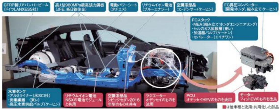
図 5 - 4 6 CLARITY FUEL CELL のシステムの構成と部品サプライヤー
