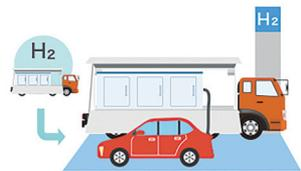
大型のトレーラーに水素供給設備を積んで、移動が可能な方式。複数の場所で運営が可能。
