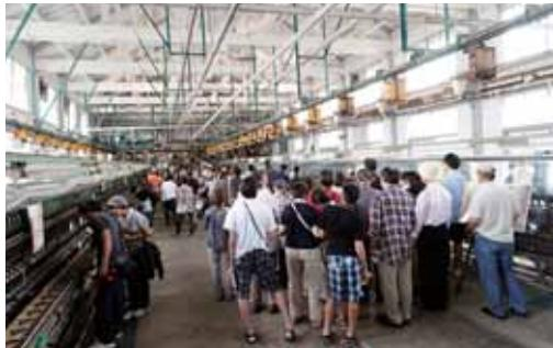
繭から生糸を取る作業が行われていた線糸場。創業当初はフランス式の線糸器300釜が設置された世界最大規模の製糸工場だった。現在は、昭和40年代以降に設置された自動線糸機が保存されている。
