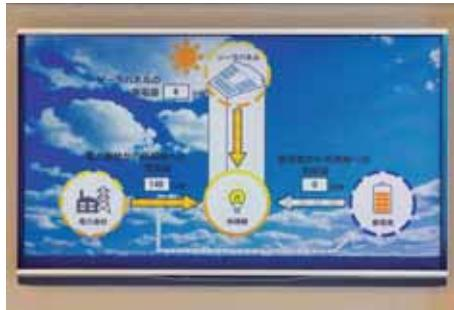
ソーラーパネル、電力会社、EVバッテリーを転用した蓄電池の電気を組み合わせたマイクログリッドでマンションの共用部にかかる電気量をコントロール。緊急時にはEVの電気を蓄電池に送ることも可能だ。
