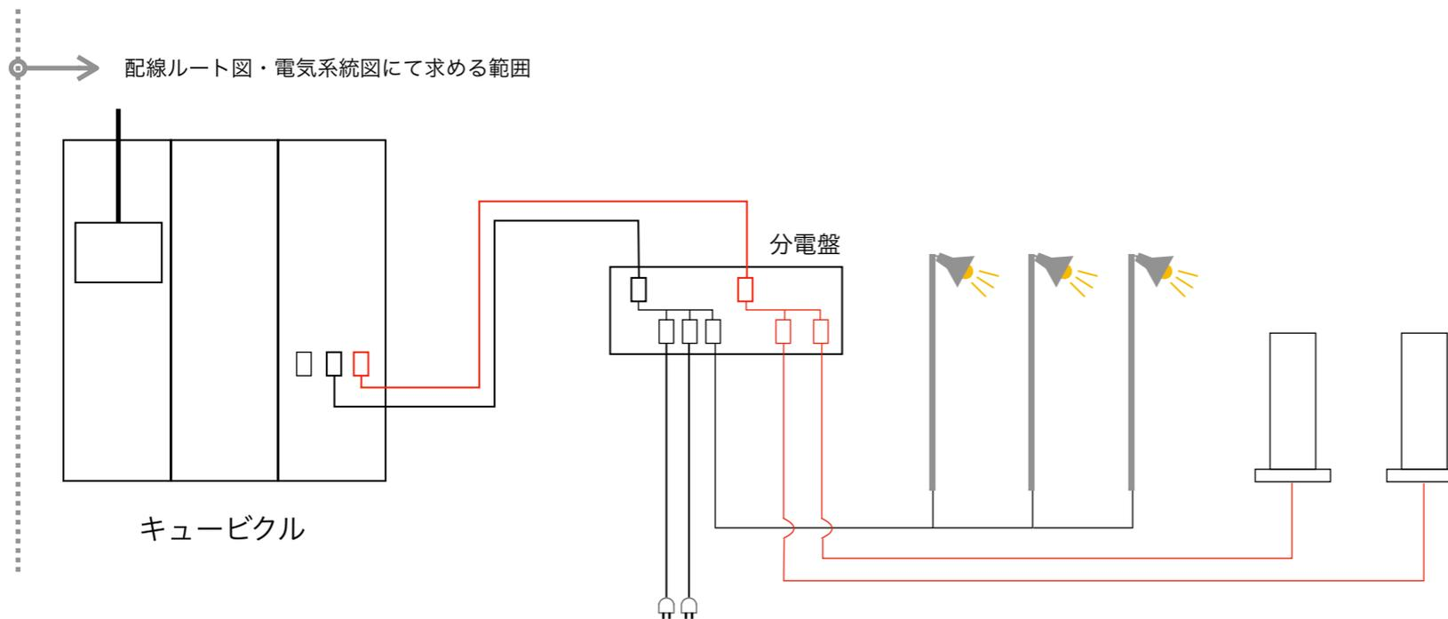
パターン③ 充電設備の専用ではない分電盤と手元開閉器盤
