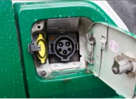
上:パートタイム4駆を採用し、暖房は「FF式灯油ヒーター」を採用した「北国でもしっかり走るコンバートEV」 下:ガソリンの給油口にプラグを装着
