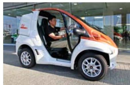
トヨタ車体が生産・販売する超小型EV「コムス」。100Vの家庭用コンセントで充電可能
