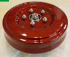
1 三菱自動車のギャランフォルティスをベースにした「OVEC-ONE」 2 開発の陣頭指揮を執った吉田寛センター長 3 4輪を独立して制御できる薄型構造のインホイールモーター
