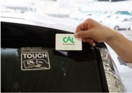
上:鳥取駅から徒歩1分という利用しやすい場所にあるカーシェアリングのスポット 下:会員カードでリアウインドをタッチするとドアが開閉するシステムを、智頭石油が独自に開発した
