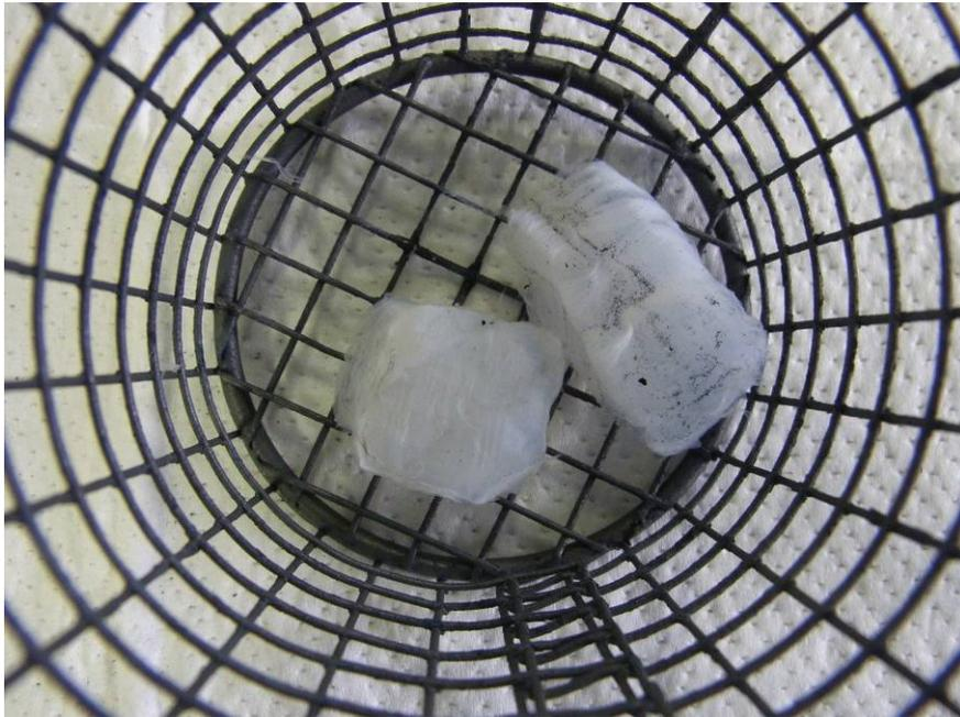
写真 3-4 燃燒残渣 (試験 4)
