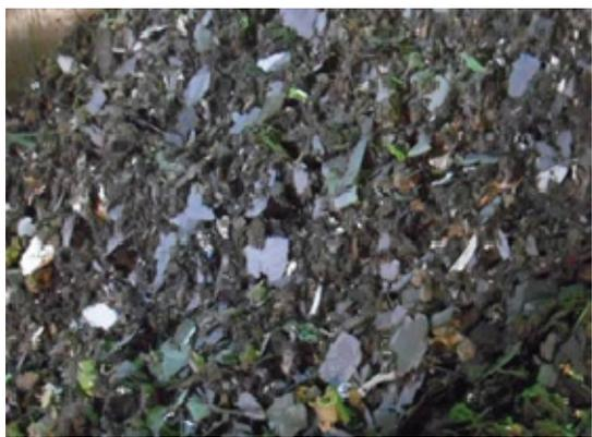
破砕後 CFRP
