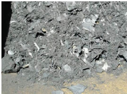
破砕後 CFRP
