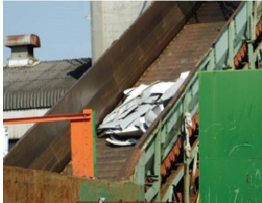
CFRP を破砕機へ投入
