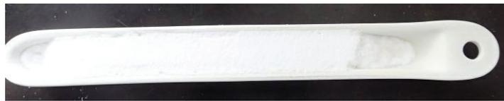
図 4 金属添加剤を過剰に添加した場合の燃焼ボート外観 (処理前)
