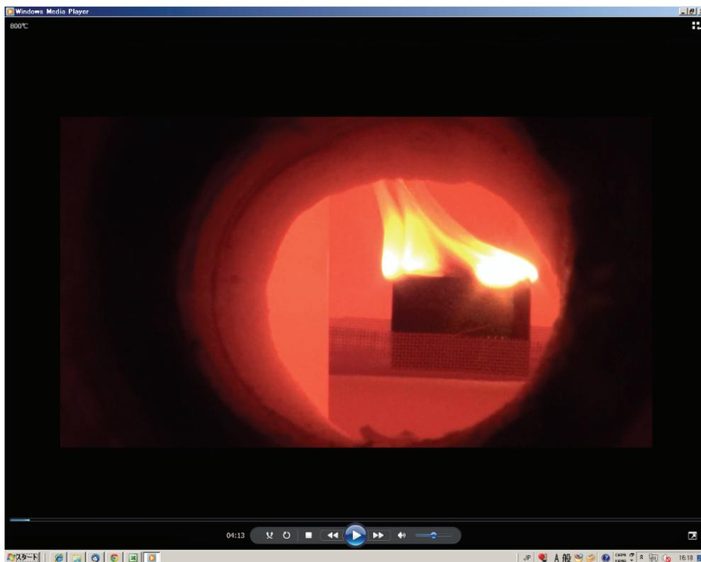
写真 3-3 (2) 投入後 15 秒 (着火) 【試験 1】
