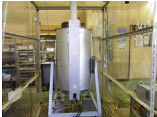
写真 2-2(1)管状電気炉
