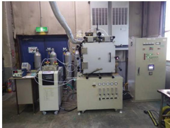
写真 3-2(1)雰囲気調整加熱炉
