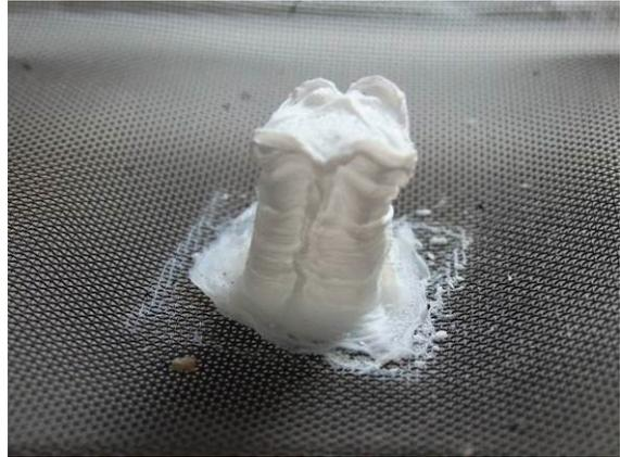
写真 3-5 試験後の燃焼残渣 (試験 1)
