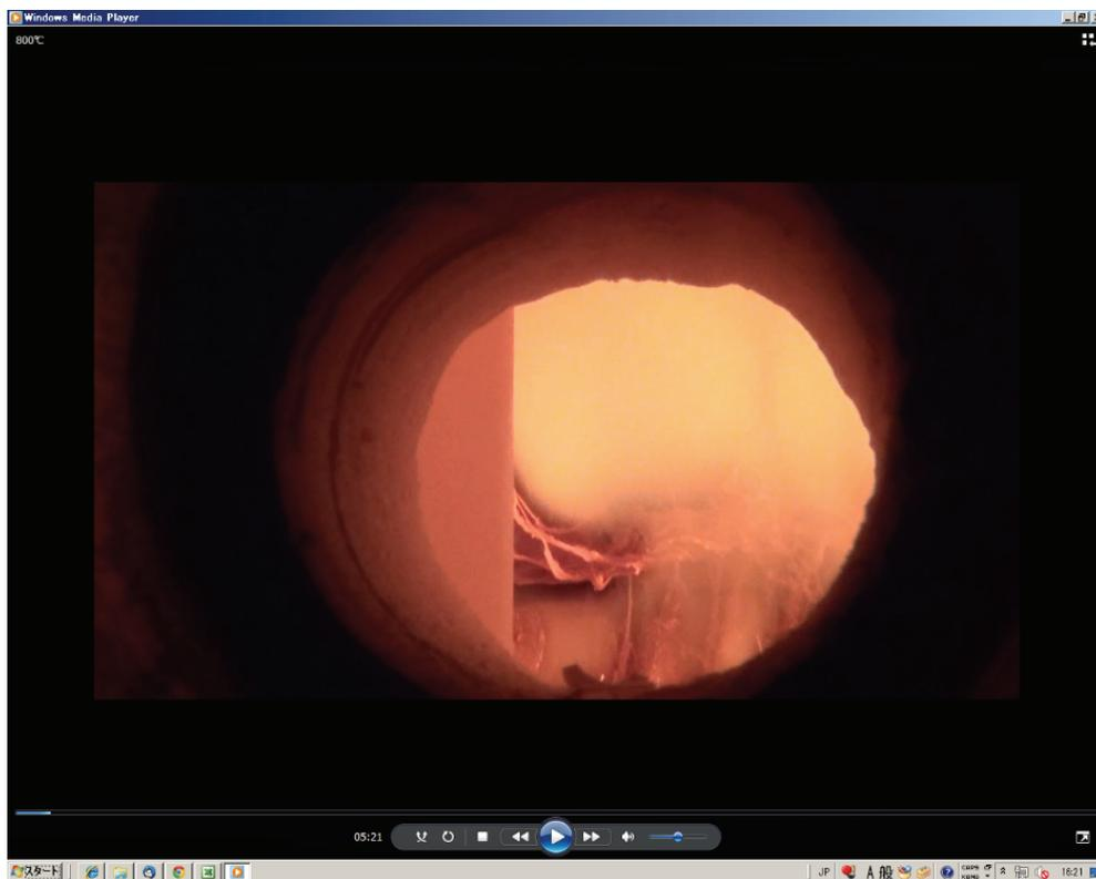
写真 3-3 (3) 投入後 83 秒 (炎を伴い燃焼中) 【試験 1】
