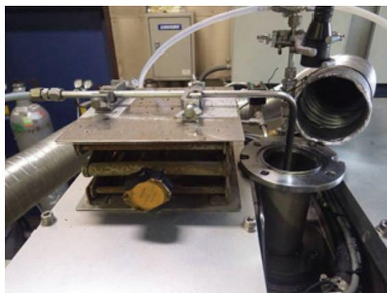
写真 3-2(2) 上部排気口、酸素濃度測定用ノズル
