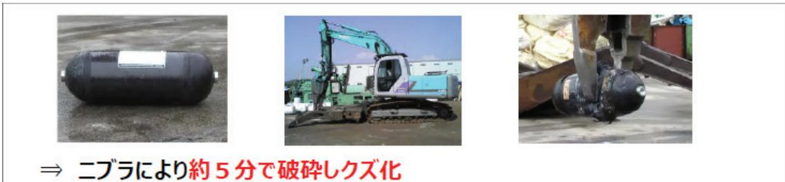
水素タンクの電炉による適正処理試験
