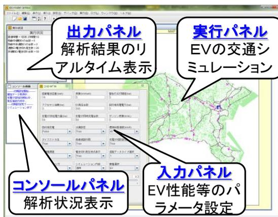
図表 3.1-1 電力中央研究所で開発された充電インフラ検討用次世代自動車交通シミュレータ (EV-OLYENTOR)
