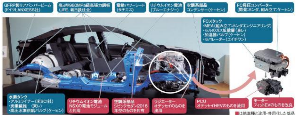
図 5-9 CLARITY FUEL CELL のシステムの構成と部品サプライヤー
