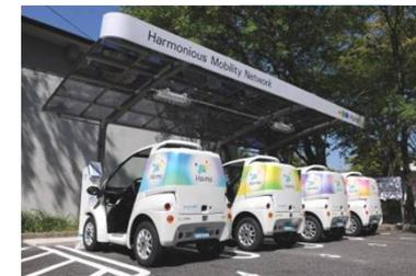
全長:2.4m 全幅:1.1m 乗車定員:1名 充電時間:6時間 航続距離:50km 最高速度:60km/h
