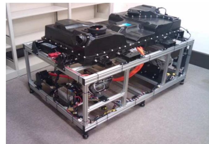
リユース蓄電池
