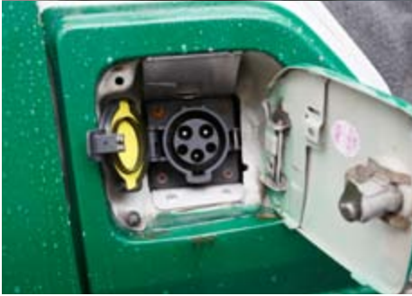
上:パートタイム4駆を採用し、暖房は「FF式灯油ヒーター」を採用した「北国でもしっかり走るコンバートEV」 下:ガソリンの給油口にプラグを装着
