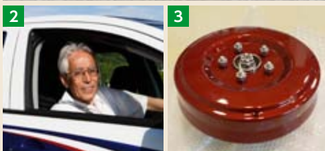
1 三菱自動車のギャランフォルティスをベースにした「OVEC-ONE」 2 開発の陣頭指揮を執った吉田寛センター長 3 4輪を独立して制御できる薄型構造のインホイールモーター
