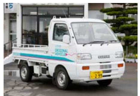
八戸市の東北自動車が製造した軽トラのコンバートEV
