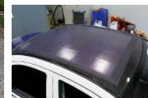
CFRPルーフと太陽電池を組み合わせたルーフはベース車に比べ40%軽い 4輪を独立して制御できるインホイールモーター
