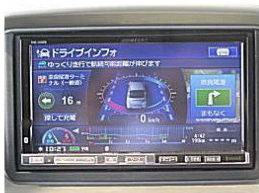
CANから電池残量情報が得られることで、電池残量の表示、残量に応じた警告、設定ルートに沿った残量予測などの諸機能が実現
