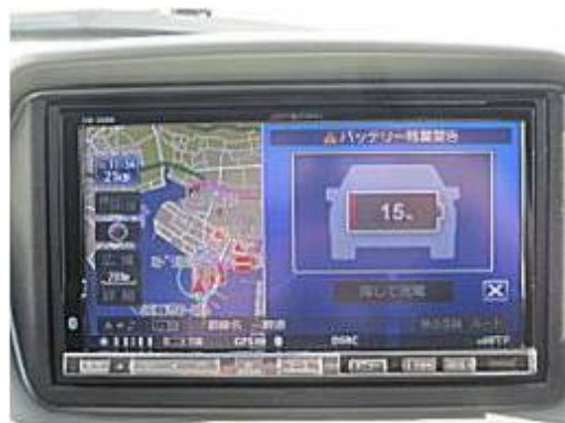
CANから電池残量情報が得られることで、電池残量の表示、残量に応じた警告、設定ルートに沿った残量予測などの諸機能が実現
