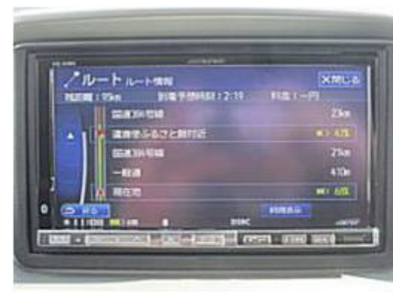
CANから電池残量情報が得られることで、電池残量の表示、残量に応じた警告、設定ルートに沿った残量予測などの諸機能が実現
