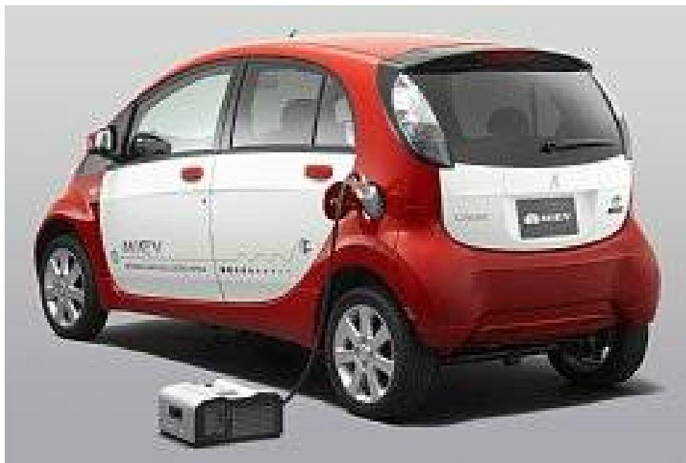
スマートグリッドにおいて開発した電気自動車の放電機能を活用し、車体外部に設置するDC/ACコンバータを開発、非常時等に家電機器などへの電源供給を可能にした。
