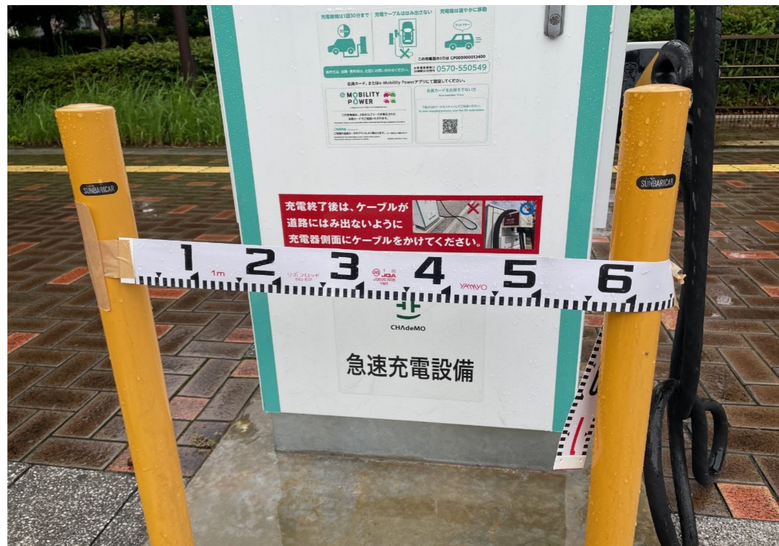
要部写真(充電設備防護用部材の間隔幅)
