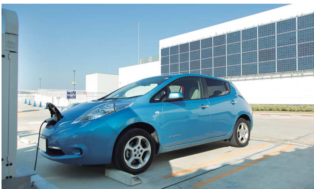
太陽光発電システムと連携した充電スタンドは、屋上駐車場に設置。連日のように利用客が訪れている。
