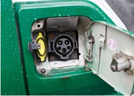
上:パパートタイム4駆を採用し、暖房は「FF式灯油ヒーター」を採用した「北国でもしっかり走るコンバートEV」 下:ガソリンの給油口にプラグを装着
