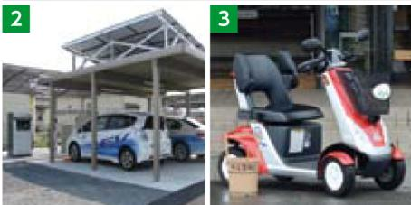
① 開館時間に利用できる充電器が2基ある道の駅・龍勢会館。屋上にソーラーパネルを設置し、ランニングコストを軽減。② 篠原駅で2014年2月まで実証実験中の「パーク＆ライド」。太陽光発電設備を備えた駐車場には、新しく蓄電池も追加整備された。③ 秩父市聖地公園では電動カート「モンパル」(ホンダ)を高齢者の移動手段に貸し出す実証実験を行って好評だ。
