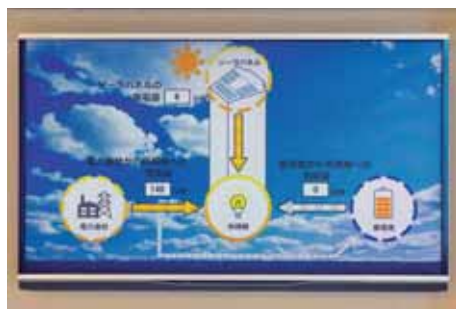
ソーラーパネル、電力会社、EVバッテリーを転用した蓄電池の電気を組み合わせたマイクログリッドでマンションの共用部にかかる電気をコントロール。緊急時にはEVの電気を蓄電池に送ることも可能だ。
